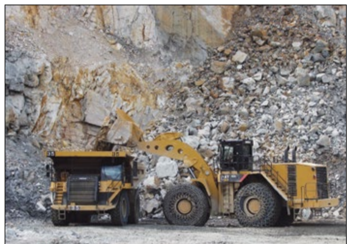
13 խորանարդ մետր շերտի ծավալով «Caterpillar 993K» մոդելի անվային ապարբարձիչը կոմբինատում շահագործվում է 2009թ. դեկտեմբերից: 2012 թվականից ձեռնարկությունն ունի այդ մակնիշի երկու ապարբարձիչ: Իսկ 90 փոննա բեռնափորողությամբ «Caterpillar 777G» մոդելի ինքնաթափող՝ 2012թ. հուլիսից: Կոմբինատն ունի այդ մակնիշի երկու ավտոինքնաթափ:
