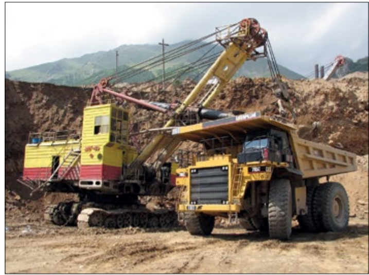
136 փոննա բեռնափորողությամբ «Caterpillar 785C» մոդելի ինքնաթափող հանքաքար տեղափոխելիս: Այն կոմբինատում շահագործվում է 2009 թվականից: 2012 թվականից ձեռնարկությունն ունի այդ մակնիշի վեց ավտոինքնաթափ
